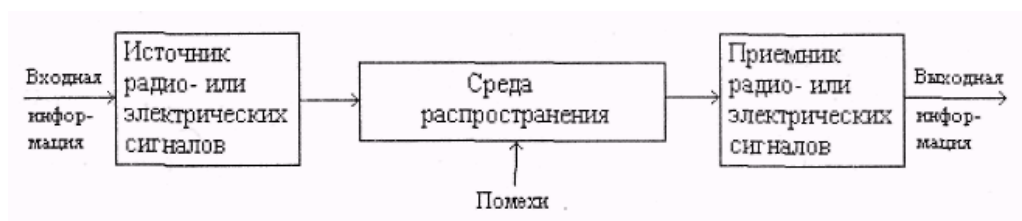
Рис. 4.4. Структура радиоэлектронного канала утечки информации
