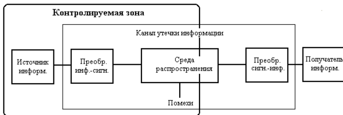
Рис. 4.1. Структура канала утечки информации
