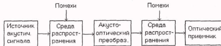
Рис. 4.8. Структура акустооптического канала утечки информации.
